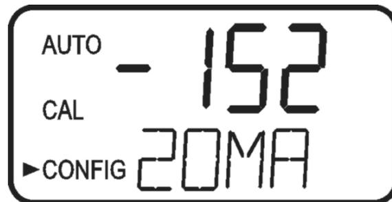
Diese Einstellung wird bei jedem Gerät geringfügig anders sein, da jedes Gerät werkseitig auf 20,00 mA eingestellt ist.
