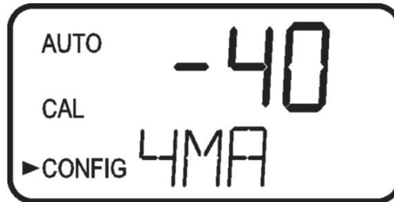
Diese Einstellung wird bei jedem Gerät geringfügig anders sein, da jedes Gerät werkseitig auf 4,00 mA eingestellt ist. Wenn die Anpassung abgeschlossen ist, drücken Sie die Taste **OK**, um die Einstellung zu speichern und zur Anpassung des 20 mA-Stromwerts zu gelangen.
